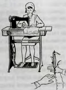
Расми 33 Мошини дарздӯзии пойӣ 1 – чархи гардона 2 – тана 3 – тасма 4 – асос 5 – чархи ҳаракатдиҳанда 6 – сипарча 7 – педал
